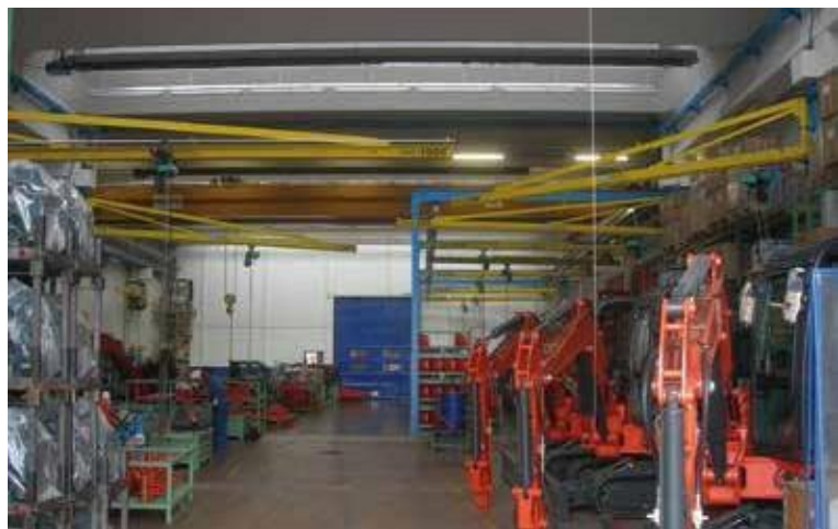
Gru a bandiera a mensola con braccio in canalina. Mod. CMM1 Gru a ponte sospeso con profili in acciaio. Mod. CMCP7
