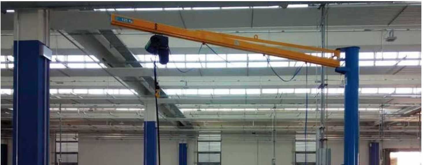
Gru a bandiera a colonna con braccio in canalina. Mod. CM1
