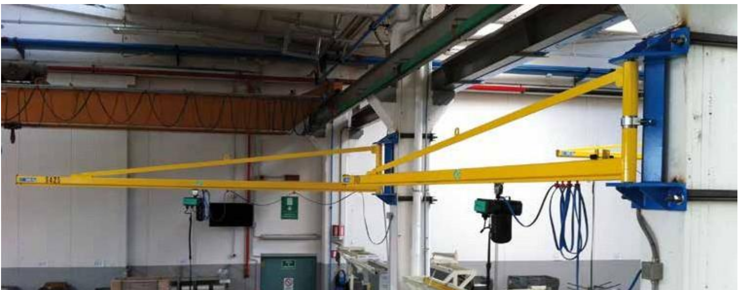
Gru a bandiera a mensola con braccio in canalina. Mod. CMM1
