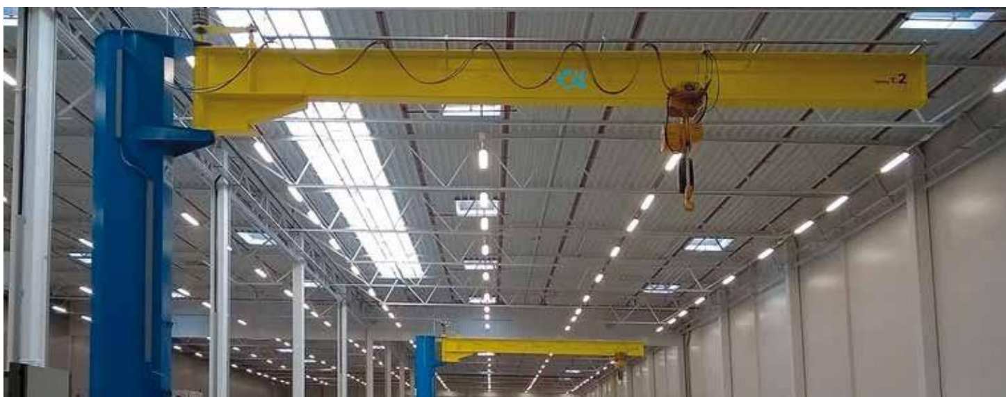
Gru a bandiera a colonna con bracc in trave a sbalzo con rotazione motorizzata. Mod. CM3 RE
