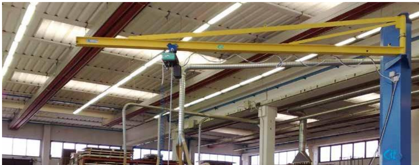
Gru a bandiera a colonna con braccio trave tirantata. Mod. CM2
