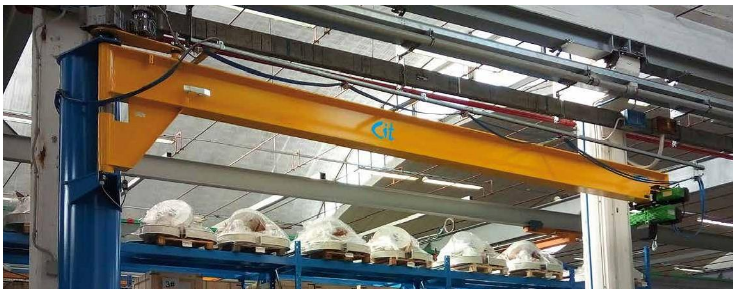
Gru a bandiera a colonna con braccio in trave a sbalzo. Mod. CM3
