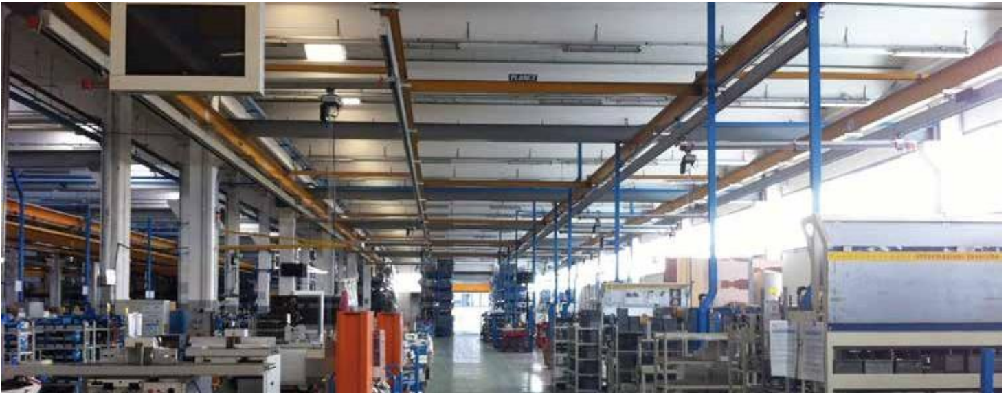
Gru a ponte sospese con profilo in alluminio. Mod. CMCP7-ALU
